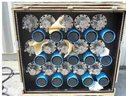
ภาพที่ 2.2-2 อุปกรณ์ Burner ในระบบหัวฉีดเผาไหม้แบบ Dry Low NOx
